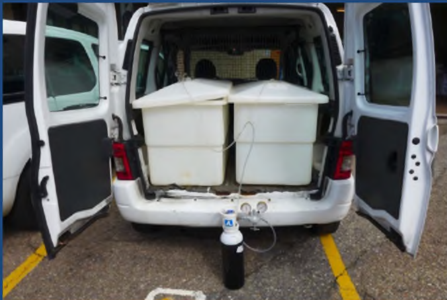
Transporte adaptado: tanques isotermos con oxigenación
